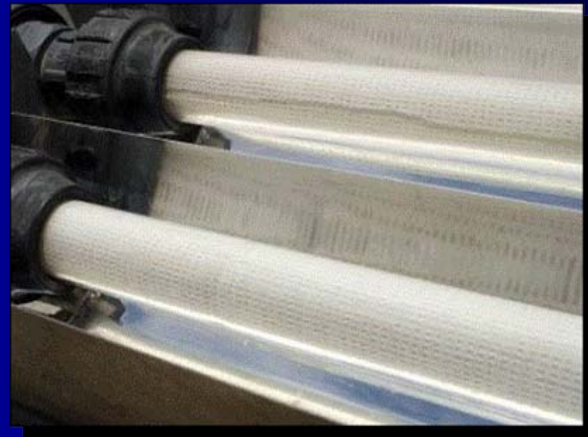
Papel de Ahlstrom ( \text{TiO}_2 ) en un reactor CPC
